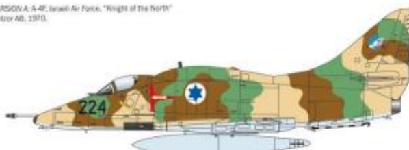
F Sand F.S. 33531 F Dark Tan F.S. 4709AP F.S. 30219 F Light Green F.S. 34227 F Light Blue F.S. 35622 F Black F.S. 4769AP F.S. 37038 F Gun Metal 4681AP F.S. 37200
