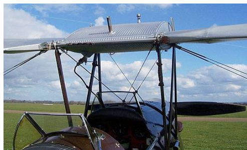
Foto a lato: Cabane con montanti a N e cavi anti torsione sul de Havilland "Tiger Moth"
